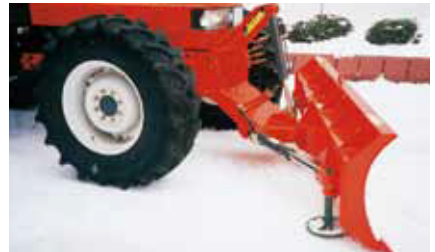
TG-2A (油圧取り出し2系統用) ●ホイルトラクター用(シリンダー2本型) ●油圧式アングルブレード。
