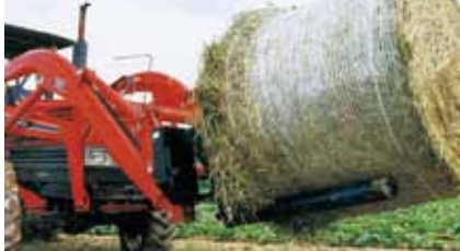
RVH-1 ロールハンドラー ●運搬、積込用。 ●油圧取り出し復動1系統。
