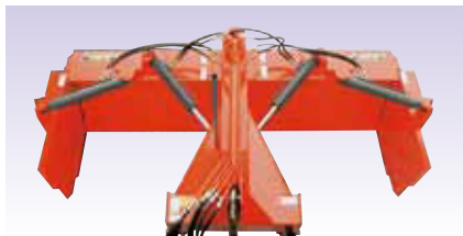
RG-3AW ●油圧式アングルブレード。 ●ガイドブレード付で、集める作業が可能です。
