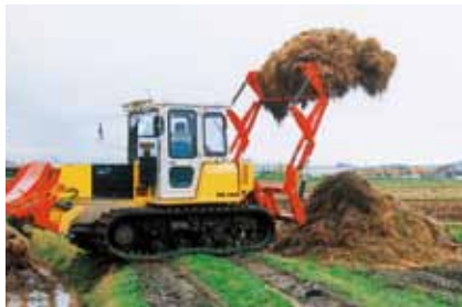
自動アオリ (オプション) ●ダンブさせると自動的に開く仕組みになっています。 △F-2SPには装着できません。
