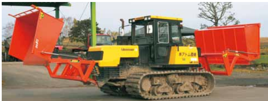
除雪板 (オプション) ●雪が横に流れず、スムーズにバケットの中に入れていくため、除雪作業が効率よくできます。
