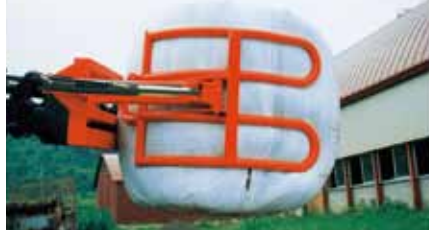
RVG-1 ロールグリッパー ●運搬、積込用。 ●油圧取り出し復動1系統。
