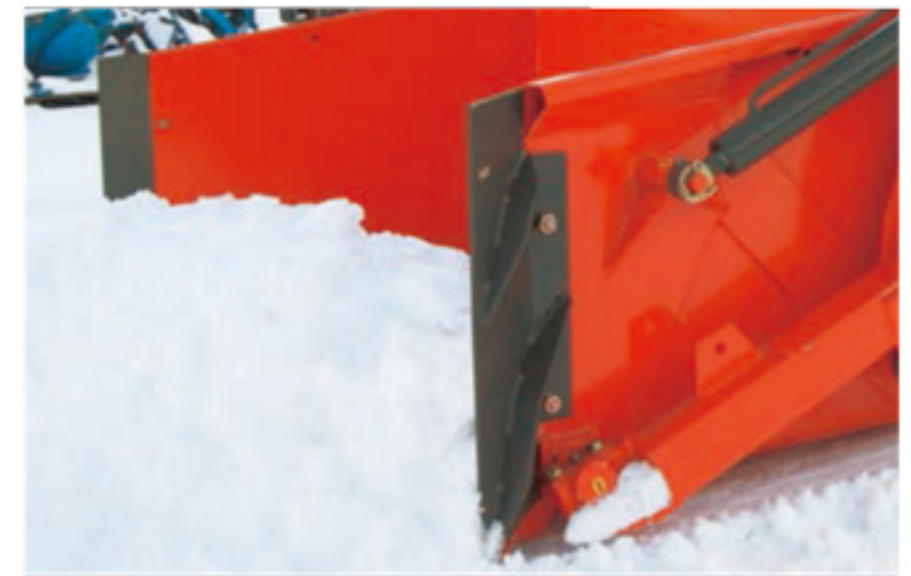
除雪板 (オプション) ●雪が横に流れず、スムーズにバケットの中に入っていくため、除雪作業が効率よくできます。
