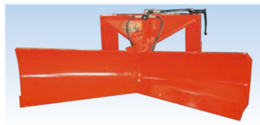
FLG-2AV ●アングリングV型ブラウ ●集める、片側排雪及び両側排雪作業ができるV型ブレード。
