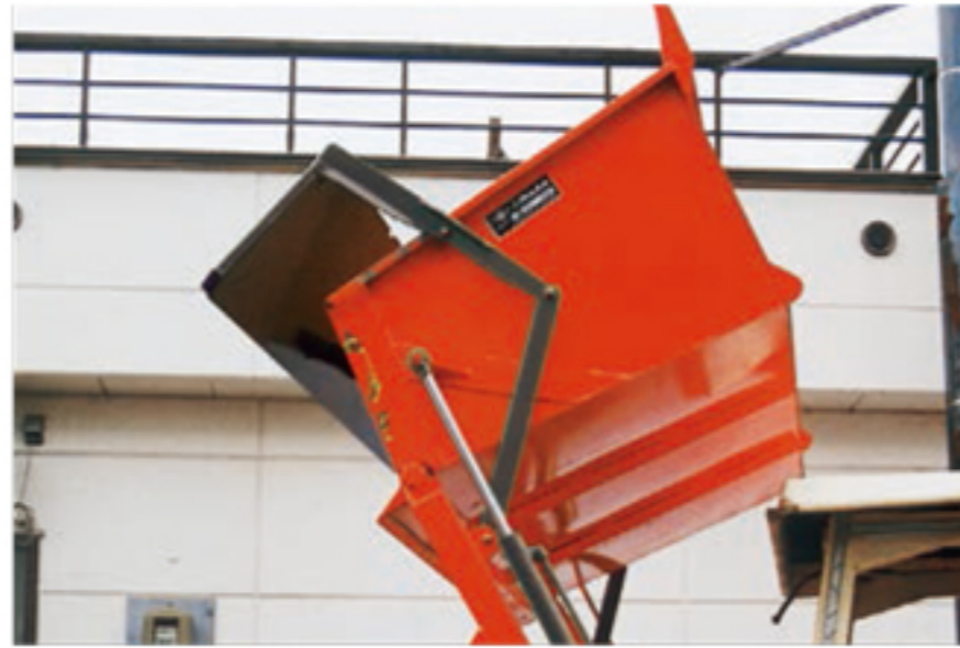
自動アオリ (オプション) ●ダンプさせると自動的に開く仕組みになっています。 △F-2SP(H)には装着できません。
