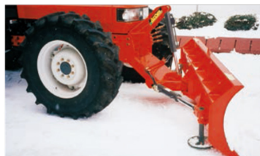
TG-2A (油圧取り出し2系統用) ●ホイルトラクター用(シリンダー2本型) ●油圧式アングルブレード。
