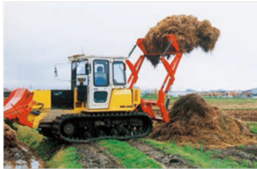
自動アオリ (オプション) ●ダンプさせると自動的に開く仕組みになっています。 △F-2SP(H)には装着できません。
