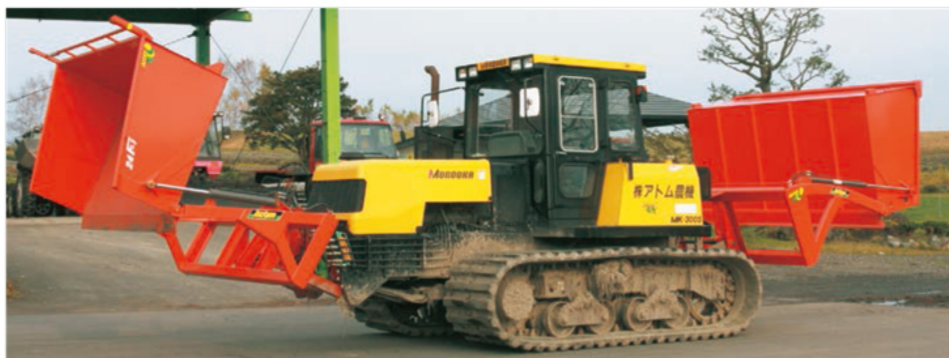
除雪板 (オプション) ●雪が横に流れず、スムーズにバケットの中に入っていくため、除雪作業が効率よくできます。
