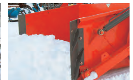
除雪板 (オプション) ●雪が横に流れず、スムーズにバケットの中に入れていくため、除雪作業が効率よくできます。
