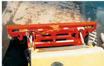
MG-2C (油圧取り出し2系統用) ●油圧式チルト機能で傾斜を水平に削土することができます。
