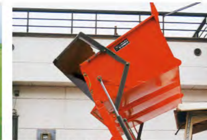
自動アオリ(オプション) ●ダンブさせると自動的に開く仕組みになっています。 △F-25P(H)には装着できません。
