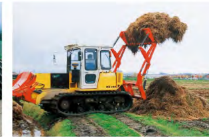
自動アオリ(オプション) ●ダンブさせると自動的に開く仕組みになっています。 △F-25P(H)には装着できません。
