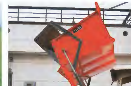
自動アオリ (オプション) ●ダンブさせると自動的に開く仕組みになっています。 △F-2SP(H)には装着できません。
