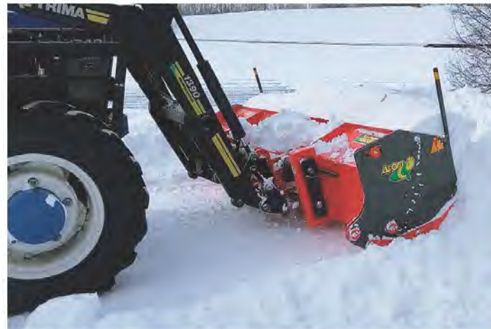
FLG28-FL フロントローダー用グレーダーFLシリーズはフローティング機構を装備しました。除雪時、地面に追従するので過度なローダーの上げ下げなどの調整が必要なくスムーズに作業することができます。
