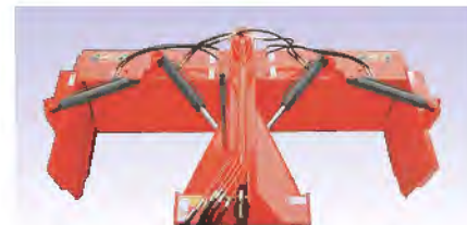
RG-3AW ●油圧式アングルブレード。 ●ガイドブレード付で、集める作業が可能です。
