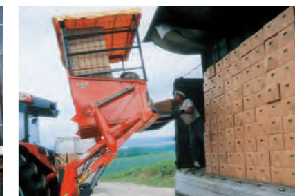
ステップ(オプション) ●箱・ミニコンテナなど運搬に便利です。 ●高所への積込作業に足かけとして利用してください。
